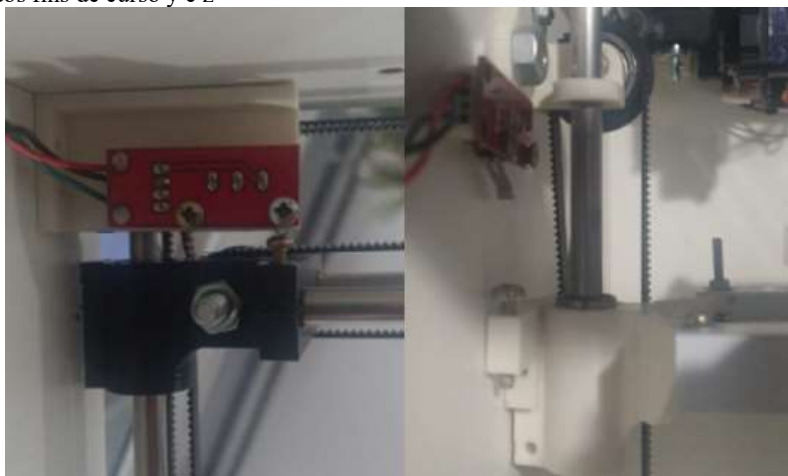
Figura 15 – Ajuste dos fins de curso y e z
