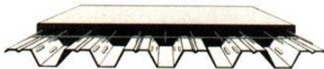
Figura 38. Laje Steel Deck
