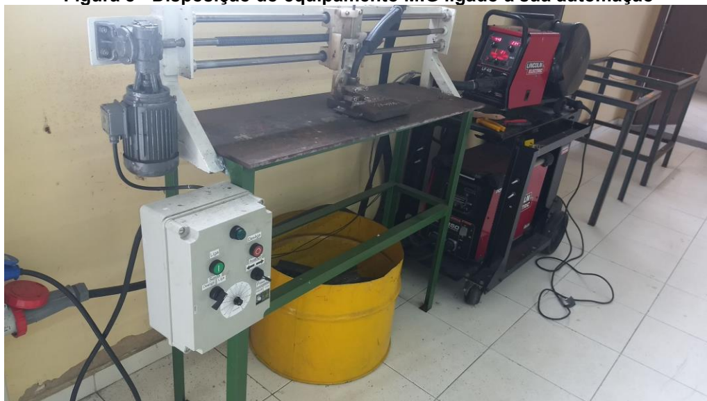
Figura 8 - Disposição do equipamento MIG ligado à sua automação
