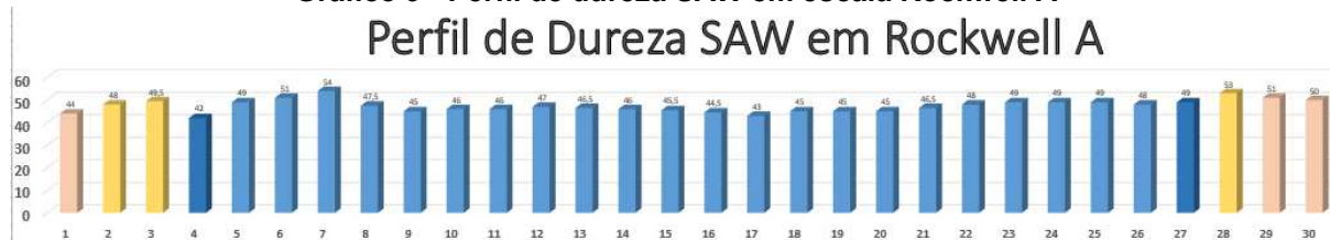
Gráfico 9 - Perfil de dureza SAW em escala Rockwell A
