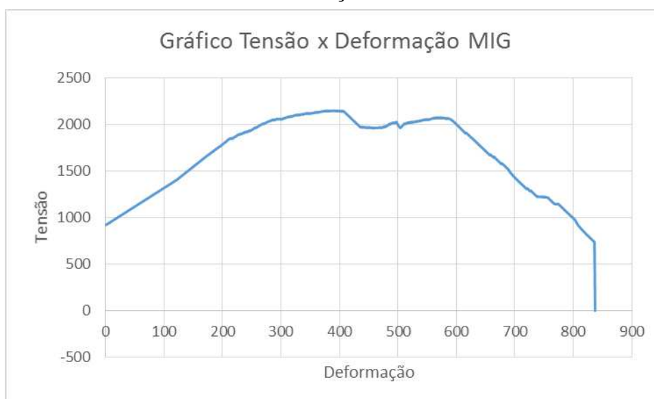
Gráfico 5 - Tensão x Deformação MIG – Ensaio de dobramento
