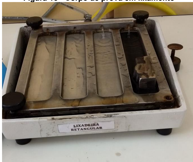
Figura 15 - Corpo de prova em lixamento
