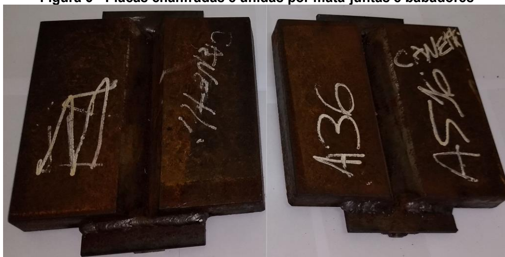
Figura 6 - Placas chanfradas e unidas por mata-juntas e babadores
