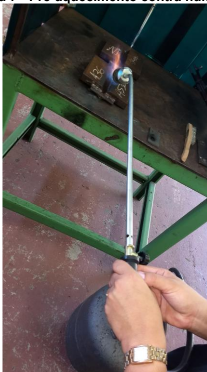
Figura 7 - Pré-aquecimento contra humidade
