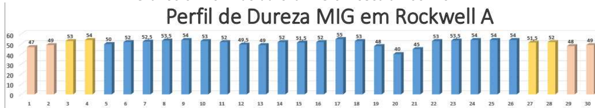
Gráfico 8 - Perfil de dureza MIG em escala Rockwell A
