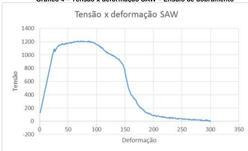
Gráfico 4 – Tensão x deformação SAW – Ensaio de dobramento
