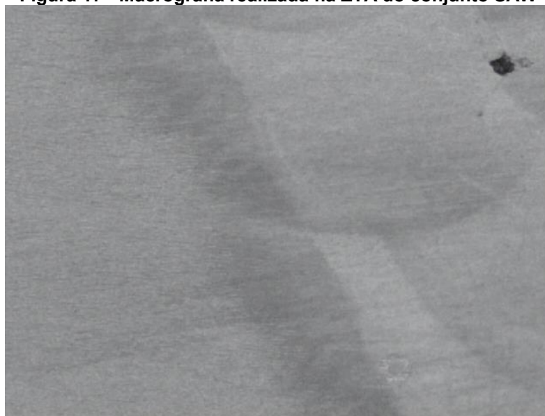
Figura 17 - Macrografia realizada na ZTA do conjunto SAW
