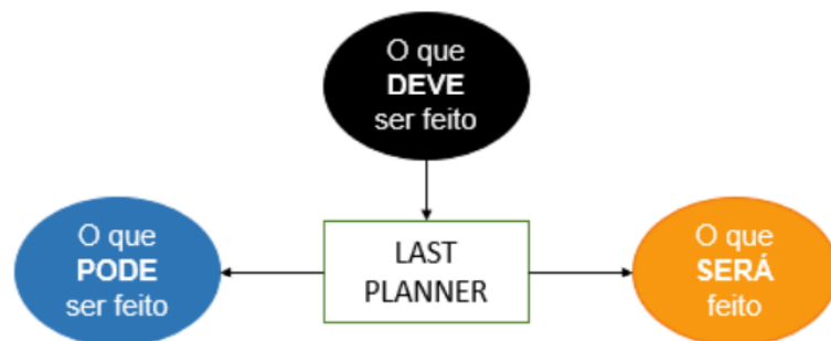
Figura 15 – Processo de Planejamento Last Planner System
