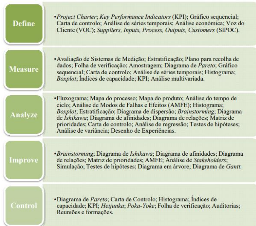
Figura 6 – Ferramentas para o sistema DMAIC
