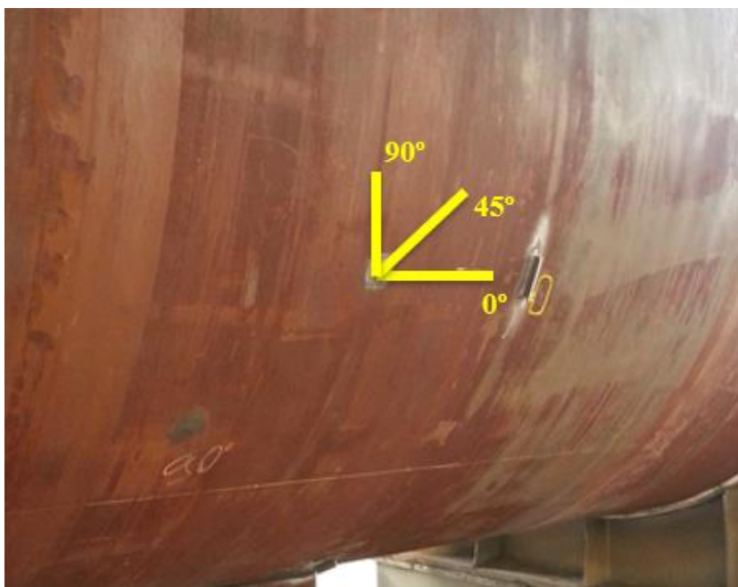
Figura 45: Direções consideradas para as deformações e tensões no costado
