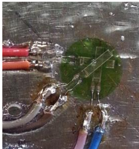
Figura 21: Extensômetro roseta retangular
