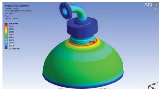
Figura 34: Tensões no bocal com carga da tubulação
