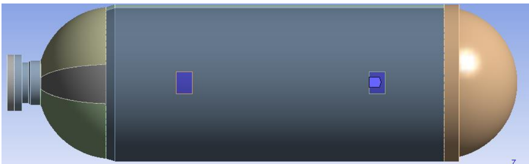
Figura 64: Condição de contorno para os suportes
