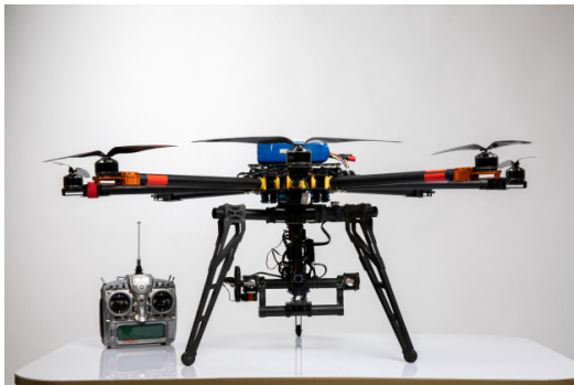
Figura 2.7: Drone (Controle de comando, Antenas e Rádio Controle)
