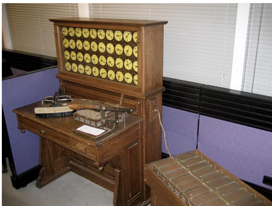
Figura 4. Máquina Tabuladora de Hollerith.
