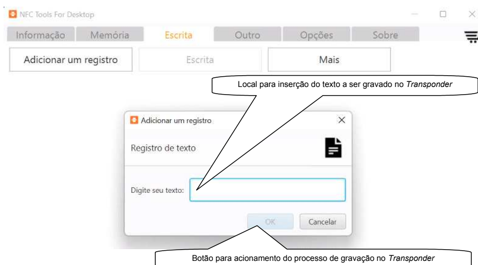
Figura 4.4 – IHM do aplicativo NFC Tools For Desktop – aba “Escrita” Fonte: Modificada de wak dev (WAKDEV, 2022)
