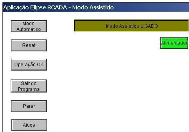
Figura 38 - Interface com a ação “Alimentador” selecionada
