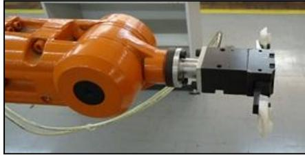
Figura 37 - Robô com a “Garra Aberta”
