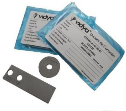
Figura 13 – Cupom de Corrosão
