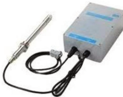
Figura 15 – Equipamento de Medição da Resistência Elétrica
