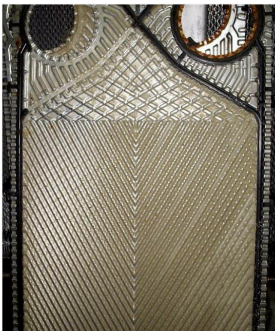
Figura 9 - Incrustação por lamas
