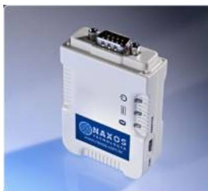
**Figura 21 - Adaptador RS232 x *Bluetooth* modelo BlueCom da Naxos**
