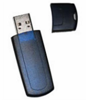
**Figura 24 - Dispositivo USB *Bluetooth* – Classe 1**
