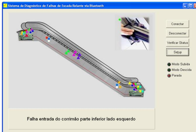
**Figura 35 - Falha interpretada pelo sistema de inspeção**
