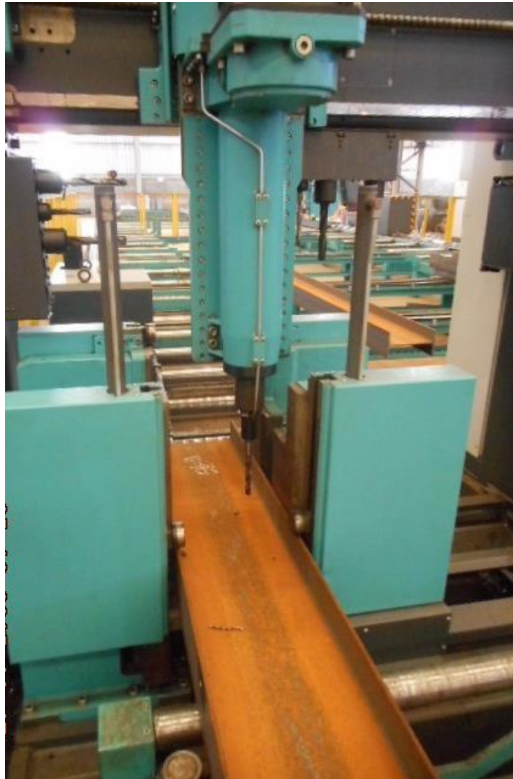
Figura 33 -Kaltenbach–Sistema automatizado de furação.
