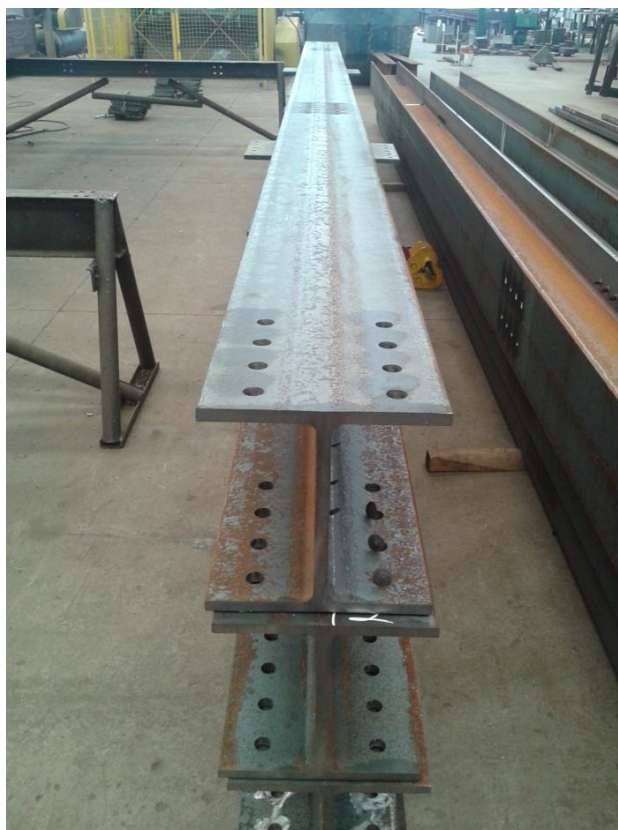
Figura 29 -Perfil HP 310 X 1,25 X 7.700.
