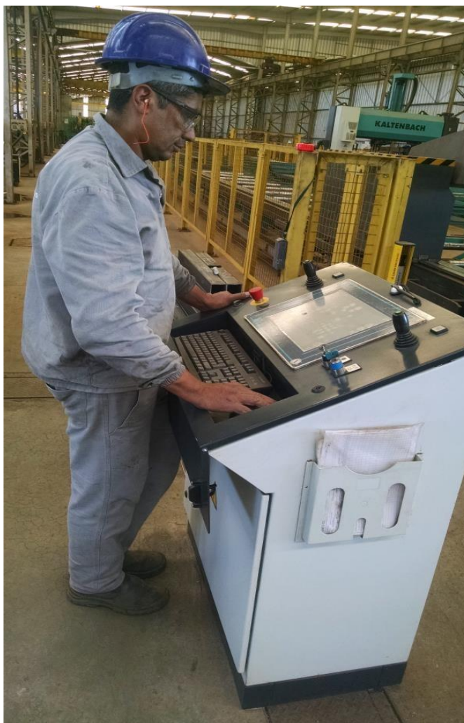
Figura 35 -Operador programando peça para o corte
