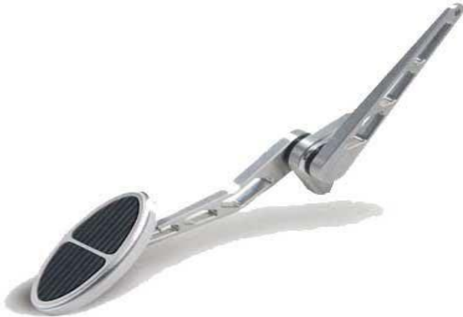
Figura 4.1 – Pedal de aceleração utilizado no veículo elétrico
