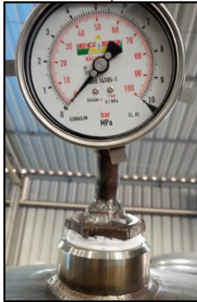
Figura 49 – Imagem do manômetro antes de inserir pressão no vaso de pressão
