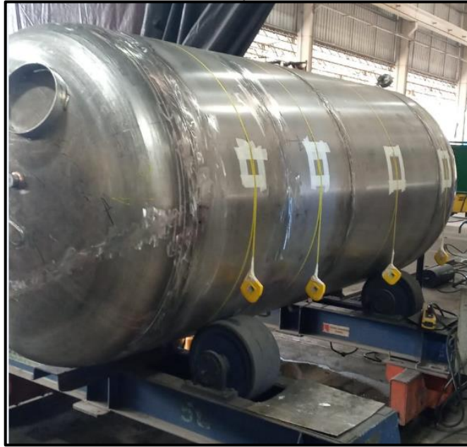
Figura 46 – Vaso de Pressão colocado nos roletes para teste
