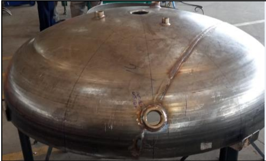
Figura 36 – Tampos inferior após soldagem das conexões
