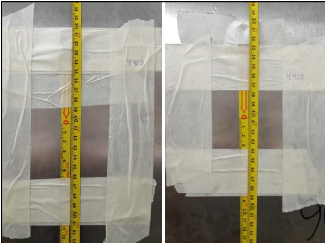
Figura 52 – Dimensão do perímetro da terceira e quarta virola da esquerda para a direita do vaso de pressão
