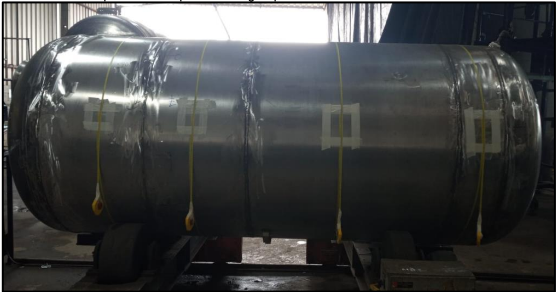
Figura 48 – Vaso de pressão completo com água para teste
