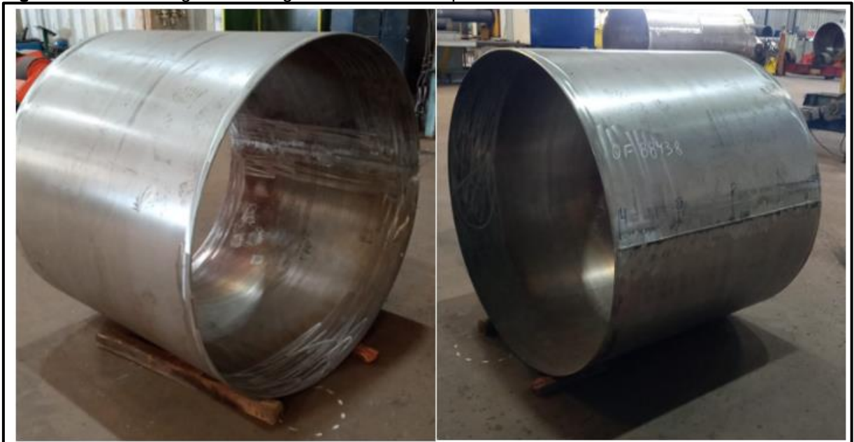
Figura 40 – Calandragem e soldagem da virola do corpo do vaso
