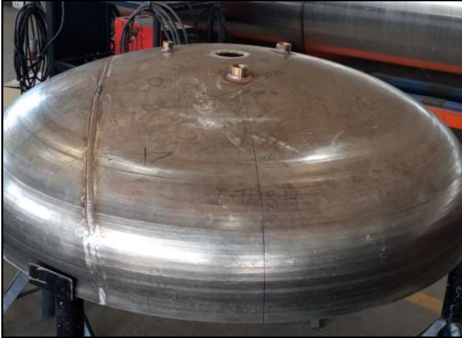
Figura 37 – Tampos inferior após soldagem das conexões
