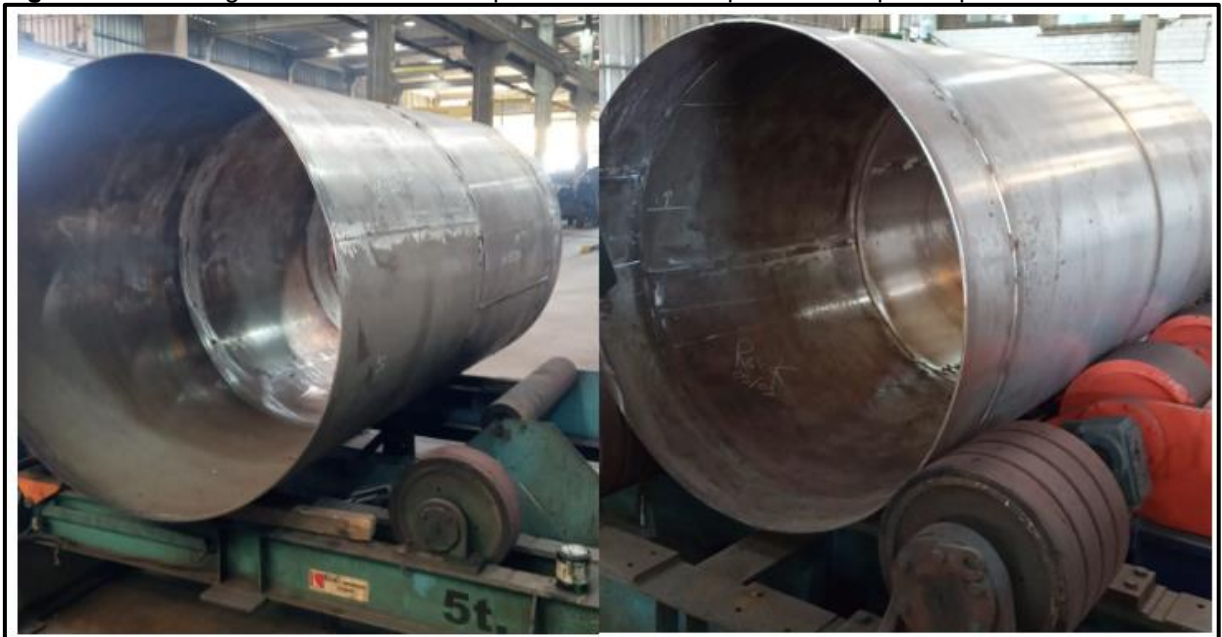
Figura 42 – Montagem das virolas do corpo lado inferior e superior da esquerda para direita
