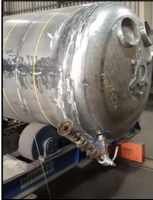
Figura 47 – Vaso de pressão preparado para enchimento de água
