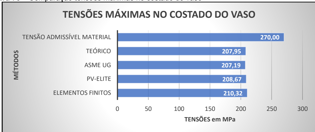
Figura 70 – Comparação tensões máximas no costado do vaso
