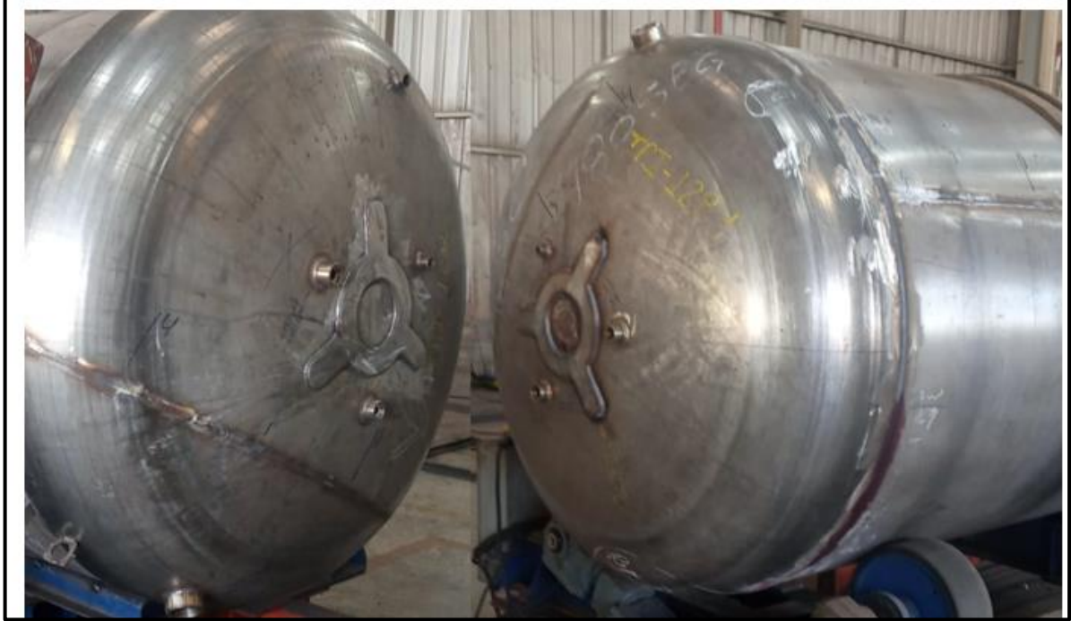
Figura 45 – Montagem dos tampos superior antes e depois da soldagem da esquerda e para a direita
