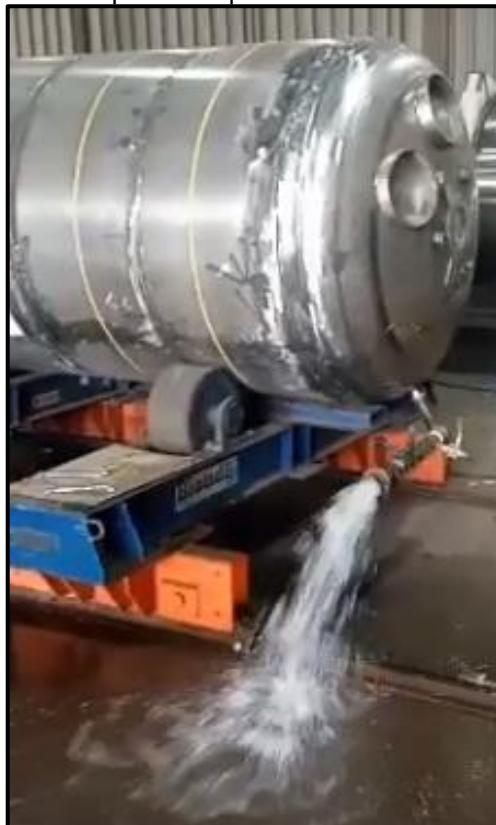
Figura 58 – Esvaziamento do vaso de pressão após teste
