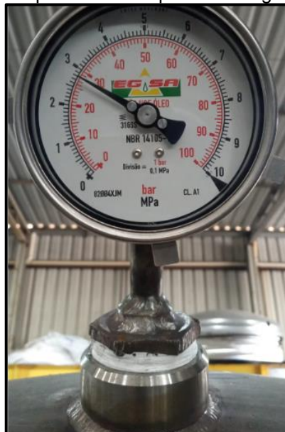
Figura 57 – Imagem do manômetro após o vaso de pressão atingir a pressão máxima do teste
