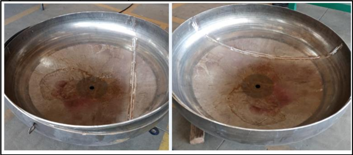
Figura 35 – Tampos após conformação
