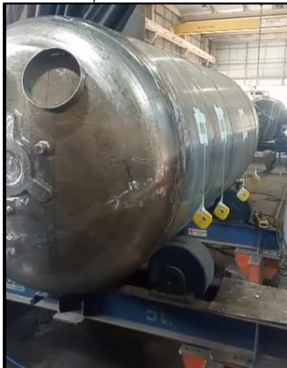
Figura 50 – Vaso de pressão com trenas para medir a circunferência durante a deformação
