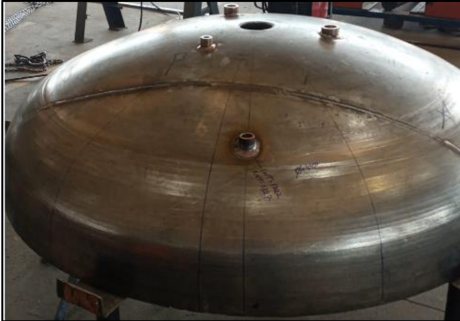
Figura 38 – Tampos superior após soldagem das conexões 1
