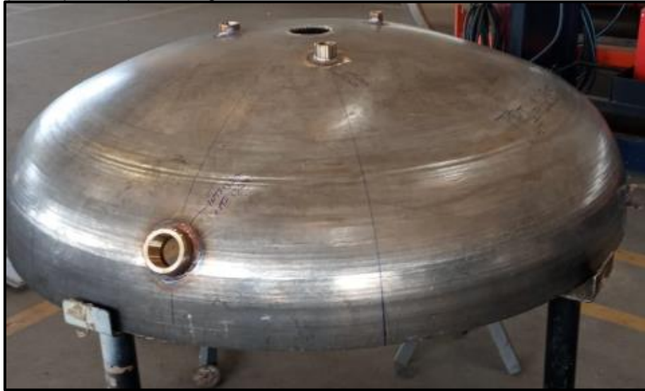
Figura 39 – Tampos superior após soldagem das conexões 2
