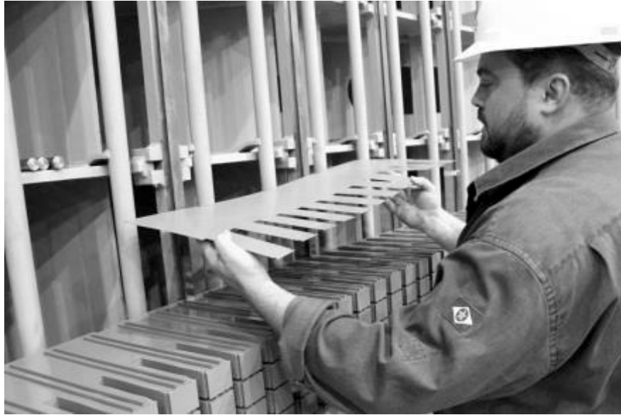
Figura 1.5: Chapas do Núcleo do Estator
