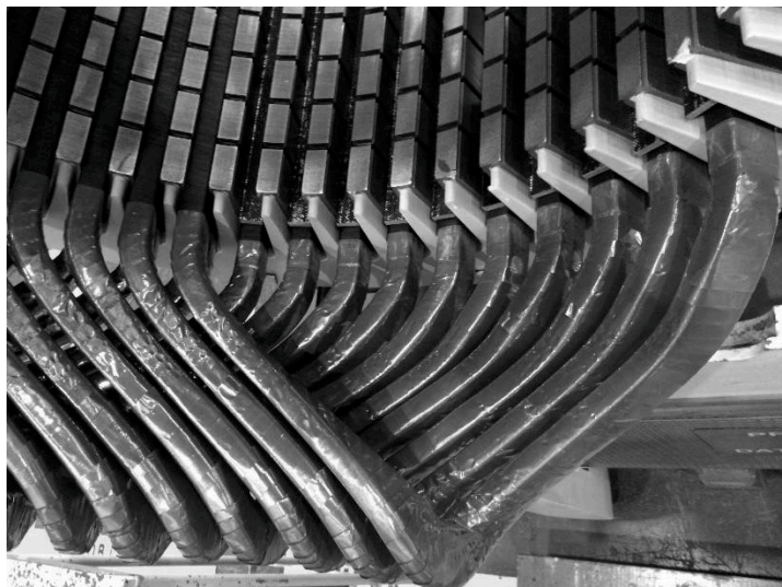
Figura 1.11: Enrolamento distribuído imbricado
