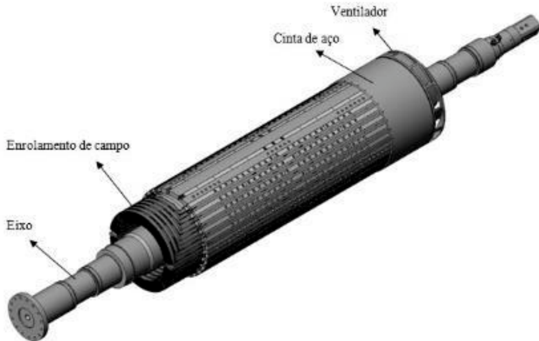
Figura 1.15: Rotor de Polos Lisos
