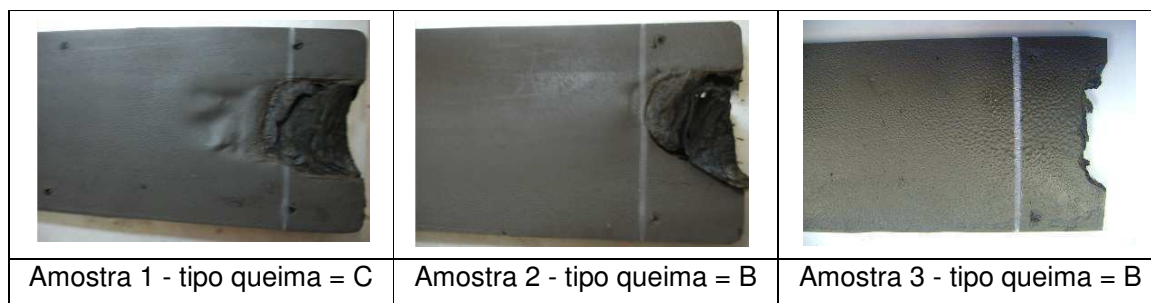
Figura 40 – Ensaio combustibilidade em tinta à base de água.
