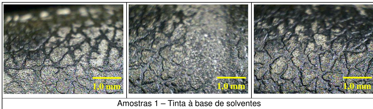
Figura 44 – Amostras 1 após ensaio de resistência à abrasão na posição “10h” (tinta à base de solventes).
