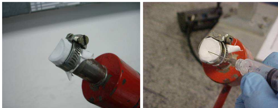
Figura 33 – Têxtil e feltro molhados com reagente.
