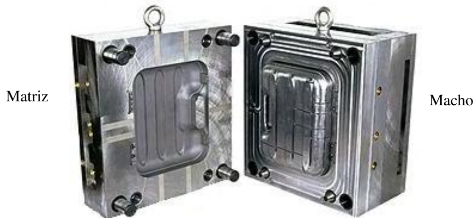
Figura 17 - Molde aberto, matriz: parte que fica presa à placa fixa da injetora, e macho: fica preso à placa móvel
