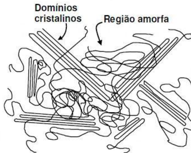
Figura 8 - Representação esquemática da estrutura de um polímero semicristalino com domínios cristalinos (ordenados) e amorfos (desordenados) (SANT'ANNA, 2007)
