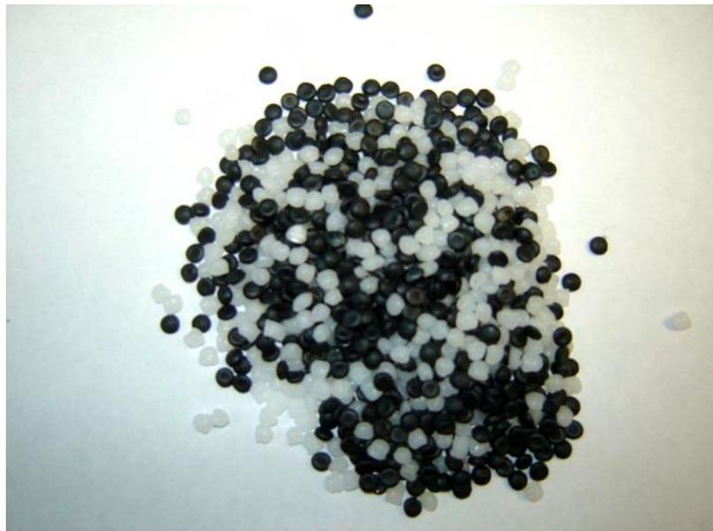
Figura 39 - Aparência da mistura final, polipropileno virgem (pontos brancos), polipropileno reciclado (pontos pretos) e *masterbatch* (pontos pretos)
