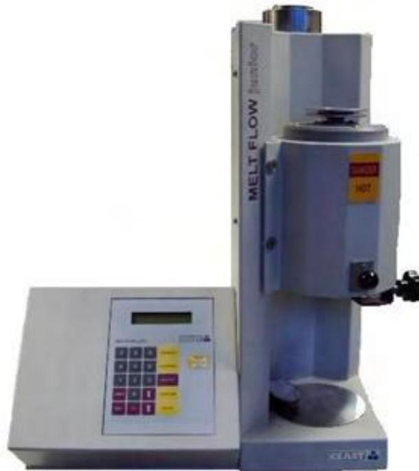
Figura 37 - Plastômetro
