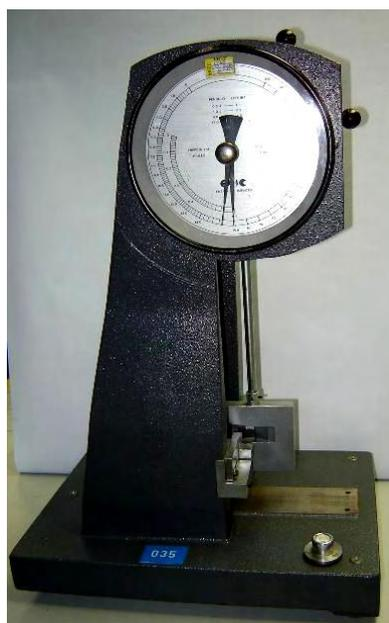
Figura 34 - Equipamento de ensaio de Impacto Charpy
