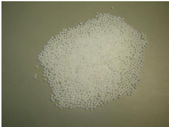
Figura 27 - Grãos de polipropileno virgem
