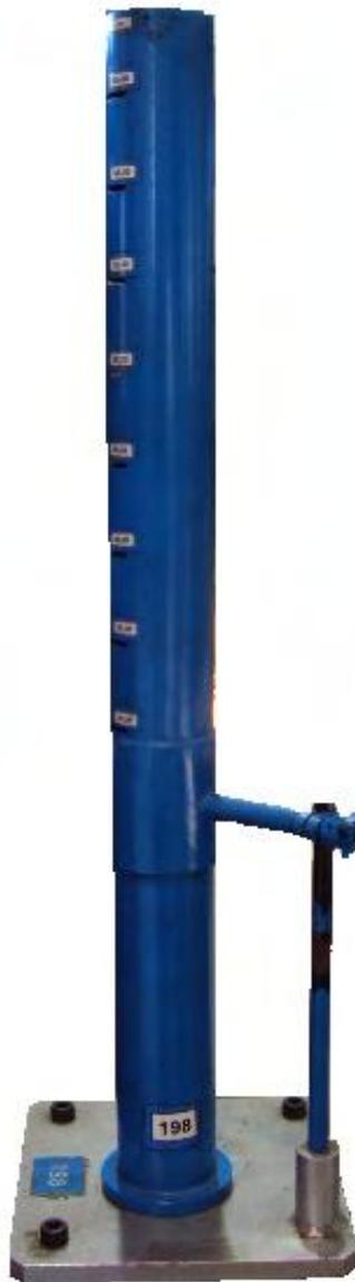
Figura 32 - Equipamento de queda de esfera
