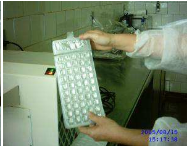
Figura 19 - Cartela Quanti -Tray após a distribuição da amostra de água
