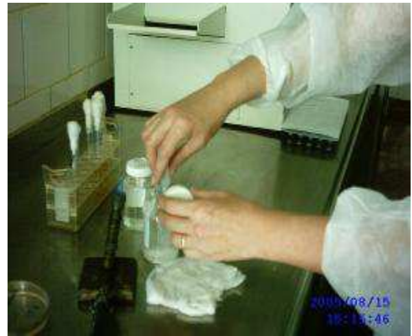
Figura 17 - Adição do reagente de Colilert nos de frascos
