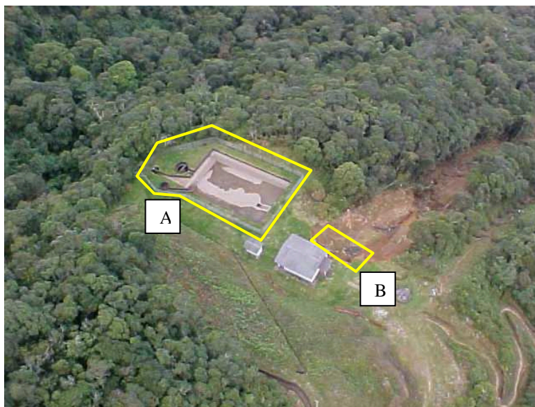
Figura 12. Imagem de sobrevôo. O ponto A da foto indica a câmara de compensação e, o ponto B, local do rompimento da adutora. Fonte: EMAE (2004)
