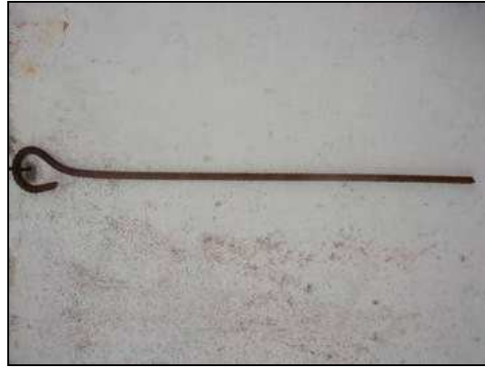
Figura 23. Grampo de aço para fixação dos colmos
