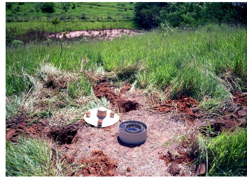
Figura 10 – Infiltrômetro de anéis e amostras retiradas com anel volumétrico
