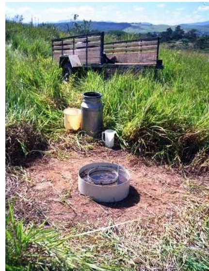
Figura 8 – Infiltrômetro de anéis sobre Brachiaria decumbens
